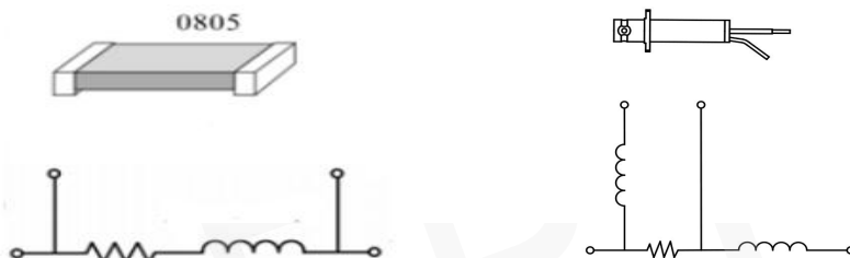
普通电阻和同轴分流器的等效电路图
